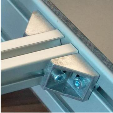
Mit M6-Schrauben und Hammermuttern für B-Typ Nut 8 können an dem Aluminiumprofil weitere Anbauteile befestigt werden.
